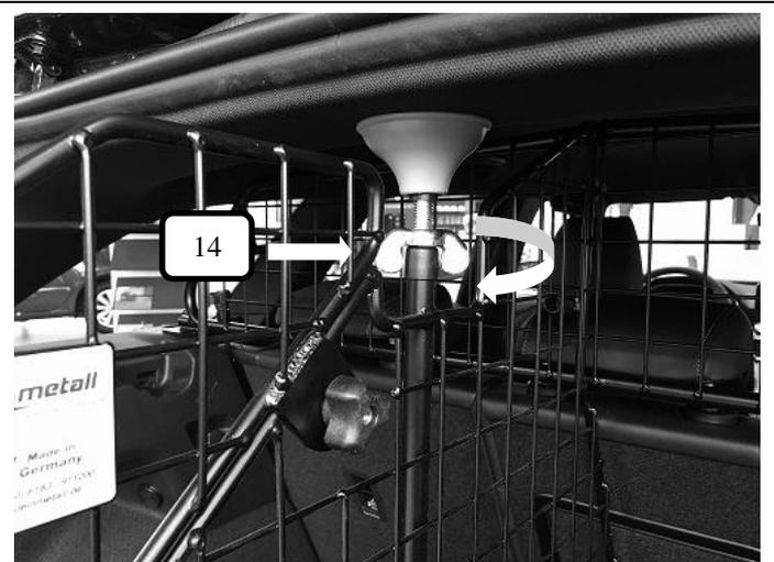
Oberen Feststellpunkt mittels drehen der Flügelmutter (Pos. 14) (Uhrzeigersinn) leicht anziehen.
