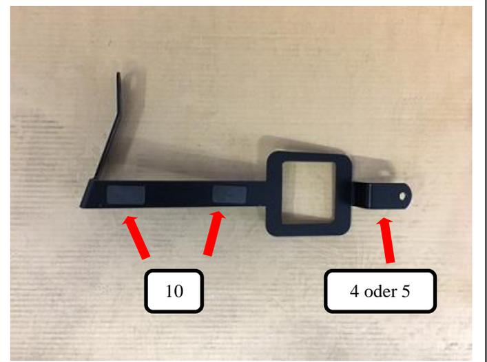
Je nach Ausstattungsvariante der Rücksitzbank (mit oder ohne Komfort-Plus), muss der Seitenhalter rechts + links in lang oder kurz (Pos. 4 oder 5) verwendet werden. Gummiauflage klein (Pos. 10) wie auf dem Bild in den Seitenhalter rechts + links in lang oder kurz (Pos. 4 oder 5) drücken.
