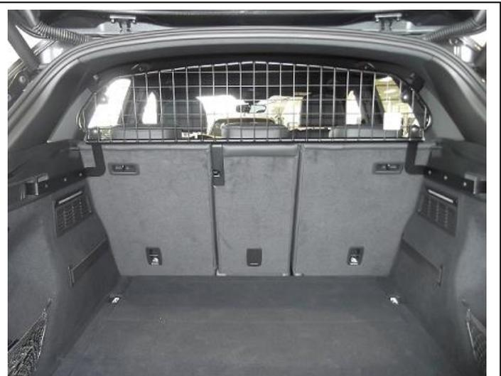
Trenngitter im montierten Zustand.
