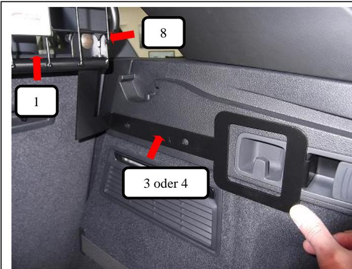
Seitenhalter rechts + links – lang oder kurz (Pos. 4 oder 5) auf beiden Seiten von vorne an das Trenngitter (Pos. 1) halten und von hinten die Schlossschraube (Pos. 8) durchstecken.
