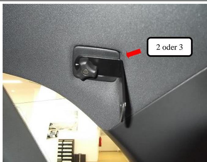
Vormontierten Dachhalter (Pos. 2 oder 3) in die vorhandenen Netzaufhängungen einhängen und festziehen.
