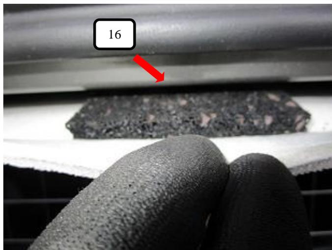
Im oberen Bereich der Hecktür die Gummiabdichtung leicht anheben und den Dachhimmel etwas nach unten ziehen. Wenn der Raumteiler mittig positioniert wird, dann muss die Gummimatte (Pos. 13) quer im Bereich des Feststellpunktes in den Hohlraum geschoben werden, wie auf dem Bild eingesetzt werden. Wenn der Raumteiler weiter rechts oder links gesetzt wird, dann sind die zwei Gummimatten (Pos. 6) zu verwenden.
