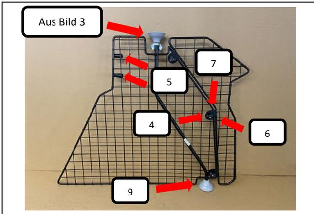
Wie im Bild dargestellt bitte die aus Bild 3 zusammengesteckte Gewindestange mit Gummifuß oben in die Rohröffnung des Teilers stecken (Feststellpunkt) und einen Gummifuß (Pos.9) unten am Teiler aufstecken. Beide Rohrendkappen (Pos. 5) auf den Teiler (Pos. 1) drücken. Aufsatz Teiler (Pos. 15) an den drei Positionen mit einer Schlossschraube (Pos. 7), Unterlegscheibe (Pos. 4) und Rändelmutter flach (Pos. 6) am Teiler (Pos. 1) wie auf Bild 5 aufschrauben und festziehen.
