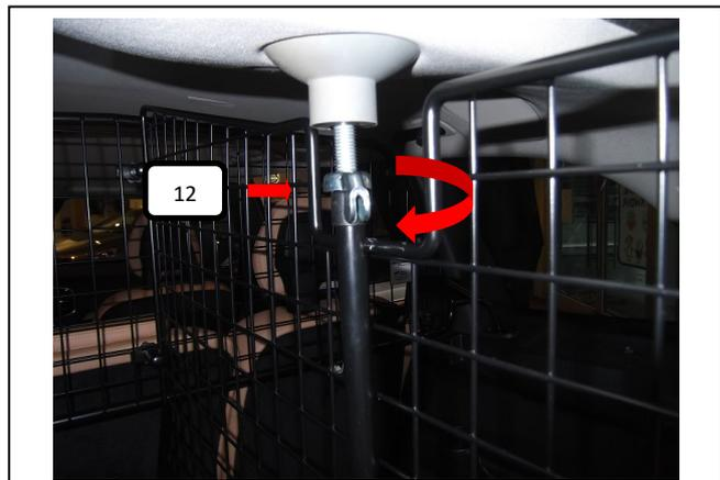
Oberen Feststellpunkt über drehen der Flügelmutter (Pos. 9) (Uhrzeigersinn) leicht anziehen.
