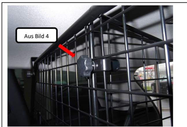
Nun den Teiler mittels der beiden Verschraubungen aus Bild 4 oben und unten am Teiler (Pos. 1) befestigen.
