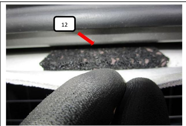
Im oberen Bereich der Heckklappe die Gummiabdichtung leicht herunterziehen und je nach gewünschter Position des Teilers die beigelegten Gummimunterlagen 8mm (Pos.12) im Bereich des Feststellpunktes in den Hohlraum schieben.
