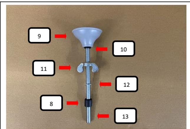
Auf die Gewindestange (Pos. 13) oben die Distanzhülse (Pos. 10) und danach den Gummifuß (Pos. 9) aufstecken. Von der anderen Seite die Flügelmutter (Pos. 11) aufdrehen und dann die U-Scheibe (Pos. 112) und Durchführungskappe (Pos. 8) aufschieben.
