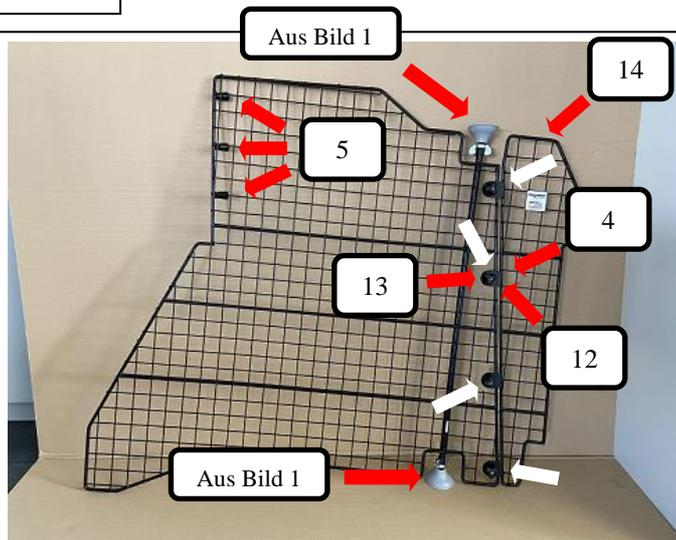
Wie im Bild dargestellt bitte die aus Bild 1 zusammengesteckte Gewindestange mit Gummifuß oben in die Rohröffnung des Teilers stecken (Feststellpunkt) und einen Gummifuß (Pos.8) unten am Teiler aufstecken. Beide Rohrendkappen (Pos. 5) auf den Teiler (Pos. 1) drücken. Den Aufsatz (Pos. 14) an allen 4 Punkten (weiße Pfeile) mit jeweils einer Schlossschraube M8x20 (Pos. 13), Unterlegscheibe (Pos. 4) und Rändelmutter flach (Pos. 12) befestigen.
