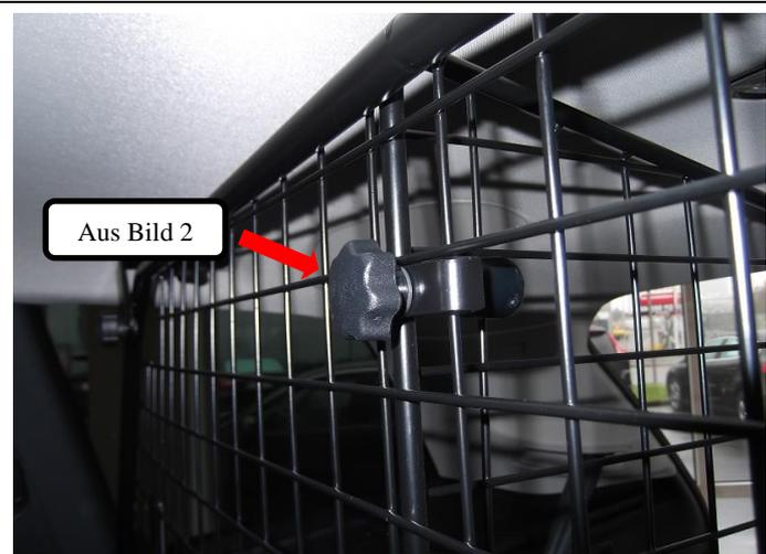
Nun den Teiler mittels der drei Verschraubungen aus Bild 2 an allen drei Positionen am Trenngitter (Pos. 1) befestigen.
