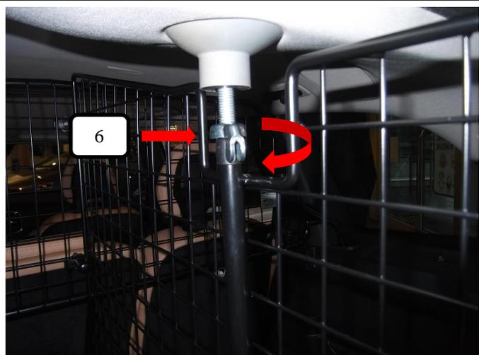
Oben und unten den Feststellpunkt über drehen der Flügelmutter (Pos. 6) (Uhrzeigersinn) leicht anziehen.
