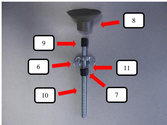
Auf die Gewindestange oben (Pos.10) die Distanzhülse (Pos. 9) und danach den Gummifuß (Pos. 8) aufstecken. Von der anderen Seite die Flügelmutter (Pos. 6) aufdrehen und dann die U-Scheibe (Pos. 11) und Durchführungskappe für Gewindestange (Pos. 7) aufschieben. Das Vormontage muss zweimal gemacht werden.
