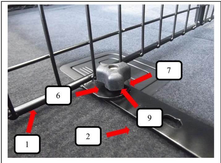
Raumteiler (Pos. 1) in das Fahrzeug einbringen und auf den Bodenhalter (Pos. 2) stellen. Jetzt von unten die Schlossschraube (Pos. 7) durchstecken, von oben eine Unterlegscheibe (Pos. 6) und Rändelmutter flach (Pos. 9) aufschrauben und festziehen.
