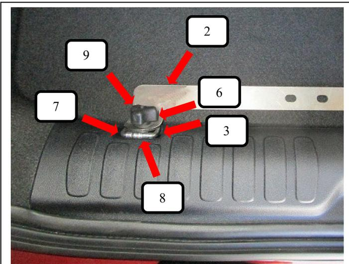
Bodenhalter (Pos. 2) wie auf dem Bild an die Verzurrösen halten, von hinten die Gegenplatte (Pos. 3) an die Verzurröse halten und eine Schlossschraube (Pos. 8) durchstecken. Jetzt eine Unterlegscheibe (Pos. 6) und Rändelmutter flach (Pos. 9) aufschrauben und festziehen.
