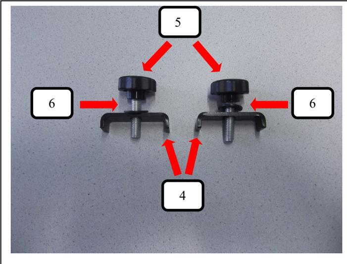
Die beiden U-Bügel (Pos.4) zusammen jeweils einer Unterlegscheibe (Pos.6) und Rändelschraube (Pos.5) wie im Bild dargestellt zusammenbauen.
