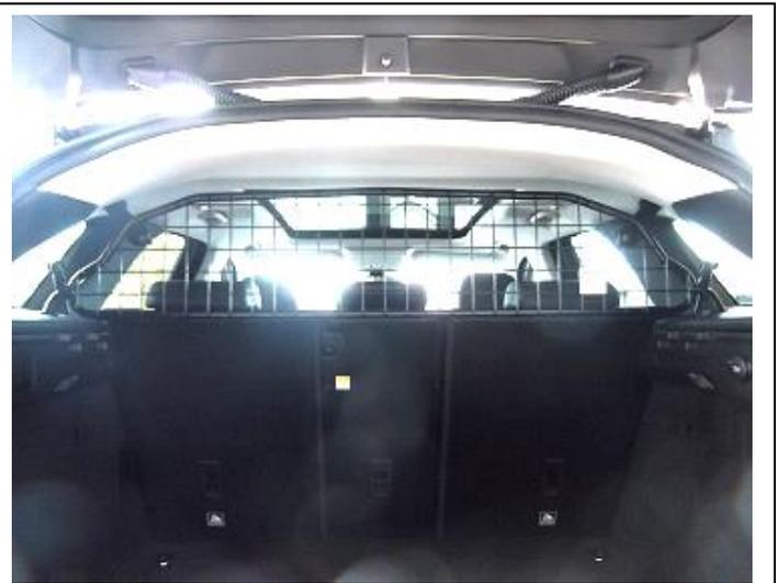
Trenngitter im fertig montierten Zustand.
