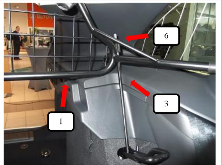
Gewindehaken (Pos. 3) jeweils rechts und links unten an der Halterung einhängen, durch die Kunststoffhülsen (Pos. 6) am Trenngitter (Pos. 1) stecken.
