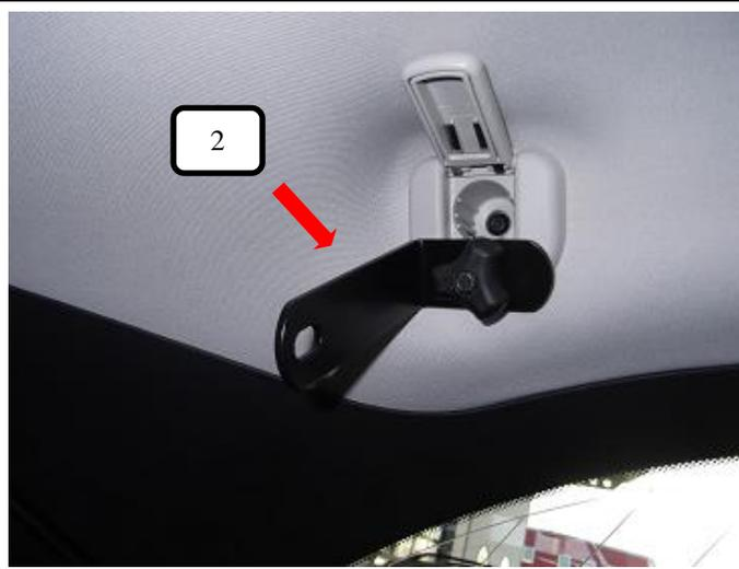
Wie im Bild dargestellt, die aus Bild 2 zusammengebauten Dachhalter (Pos. 2) jeweils rechts und links oben in den Fahrzeugseitigen Aufnahmeösen einhängen, festhalten und leicht anziehen.
