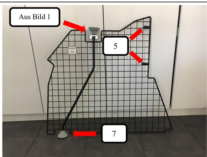
Wie im Bild dargestellt bitte die aus Bild 1 zusammengesteckte Gewindestange mit Gummifuß oben in die Rohröffnung des Teilers stecken (Feststellpunkt) und einen Gummifuß (Pos.7) unten am Teiler aufstecken. Beide Rohrendkappen (Pos. 5) auf den Teiler (Pos. 1) drücken.
