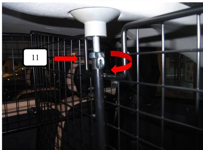
Oberen Feststellpunkt über das drehen der Flügelmutter (Pos. 11) (Uhrzeigersinn) leicht anziehen.
