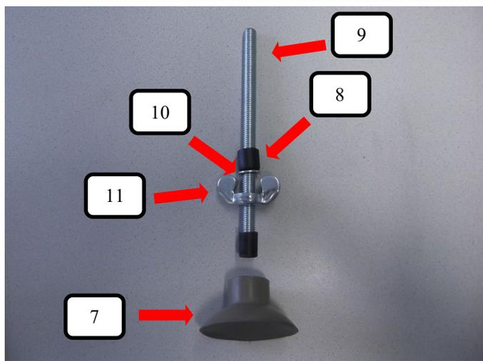
Die Gewindestange oben (Pos.9) auf einen Gummifuß grau (Pos.7) wie im Bild dargestellt aufstecken. Danach die Flügelmutter (Pos. 11) drauf drehen und die Unterlegscheibe (Pos. 10), sowie die Distanzhülse (Pos. 8) aufstecken.
