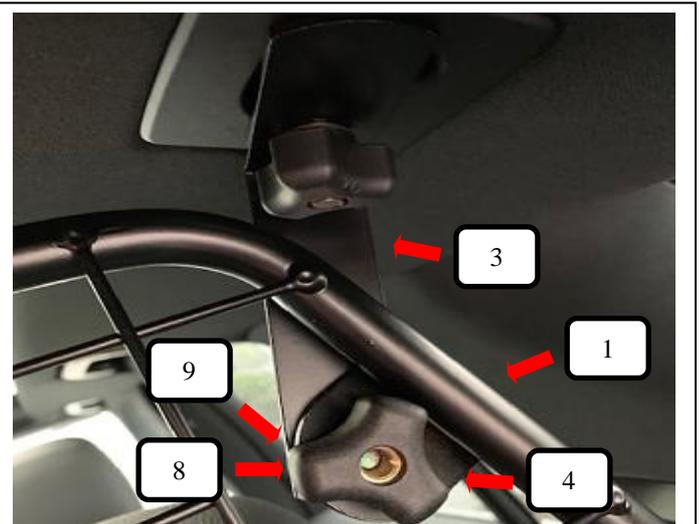
Trenngitter (Pos. 1) von hinten an den Dachhalter (Pos. 3) halten und von vorne eine Schlossschraube (Pos. 9) durchstecken. Jetzt eine Unterlegscheibe (Pos. 8) und Rändelmutter flach (Pos. 4) aufschrauben und festziehen.
