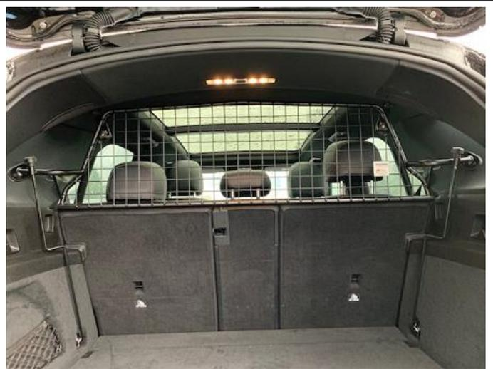
Trenngitter im montierten Zustand.
