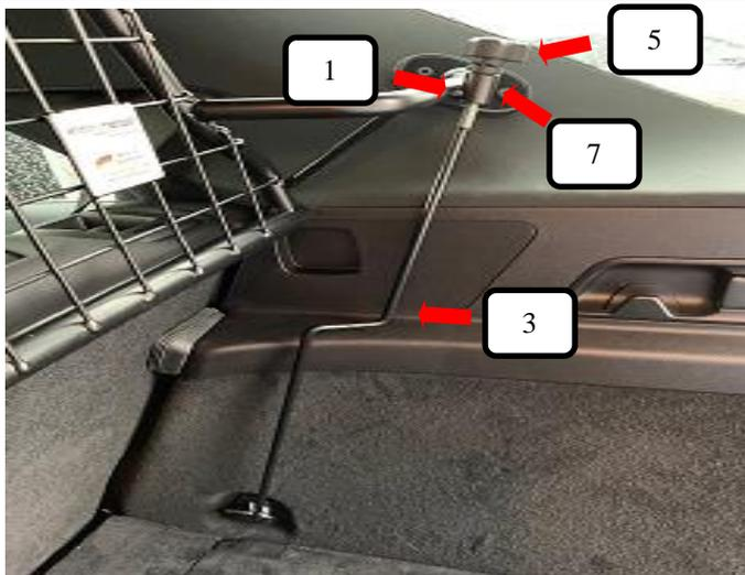
Gewindehaken (Pos. 3) unten an der Verzurröse einhängen, nach oben durch das Trenngitter (Pos. 1) sowie Kunststoffhülse (Pos. 7) schieben. Jetzt eine Rändelmutter gewölbt aufschrauben und festziehen.
