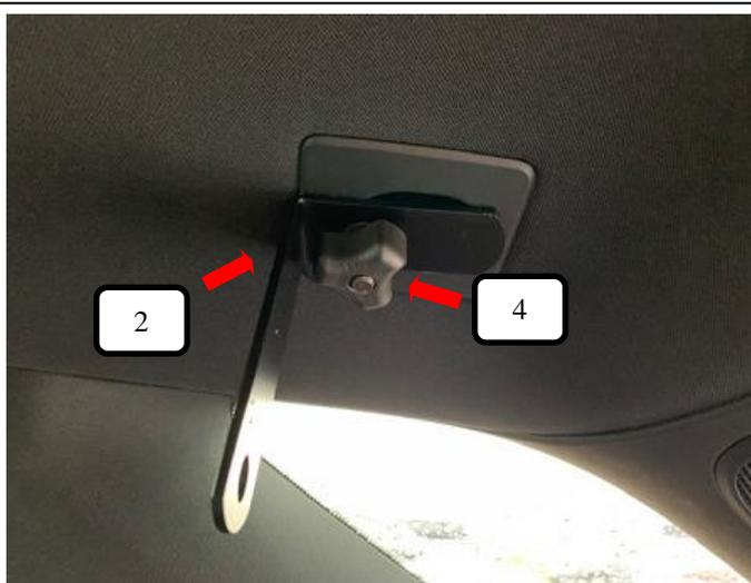
Aus Bild 2 vormontierten Dachhalter (Pos. 3) in die Netzaufhängungen im Dach einhängen, jetzt die Rändelmutter flach (Pos. 4) anziehen.
