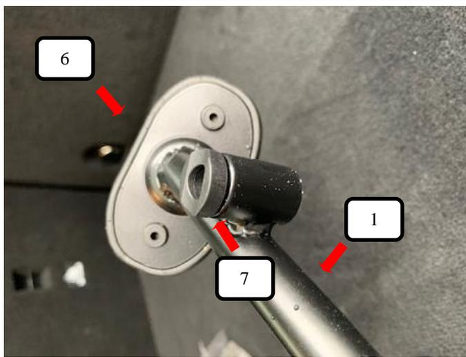
Kunststoffhülse (Pos. 7) in das Trenngitter (Pos. 1) und Gummiauflage groß (Pos. 6) auf das Trenngitter (Pos. 1) stecken.
