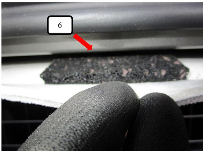
Im oberen Bereich der Hecktür die Gummiabdichtung leicht anheben und je nach gewünschter Position des Teilers die zwei beigelegten Gummimunterlagen 8mm (Pos.6) im Bereich des Feststellpunktes in den Hohlraum schieben.
