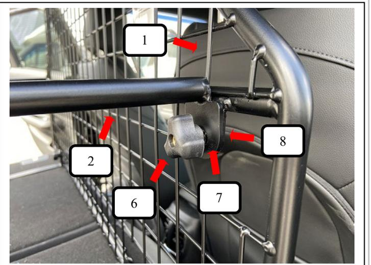
Strebe rechts + links (Pos. 2) an das Trenngitter (Pos. 1) halten, von vorne eine Rundkopfschraube (Pos. 8) durchstecken und von der anderen Seite eine Unterlegscheibe (Pos. 7) sowie Rändelmutter flach (Pos. 6) aufschrauben und festziehen.
