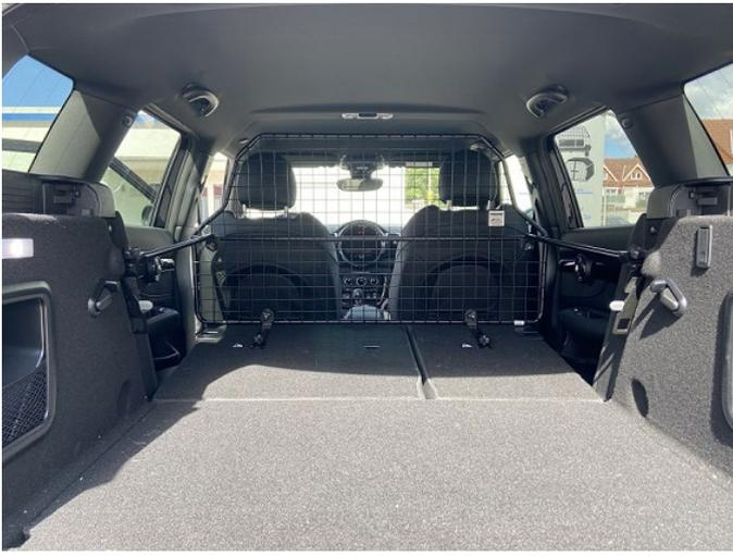
Trenngitter im montierten Zustand.
