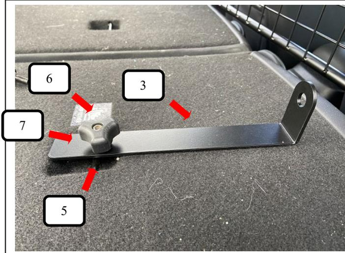
Gewindehaken kurz (Pos. 5) in die Isofix Verankerung eingehängen und das Gewinde durch den Bodenhalter (Pos. 3) schieben. Jetzt eine Unterlegscheibe (Pos. 7) und Rändelmutter flach (Pos. 6) aufschrauben und festziehen.
