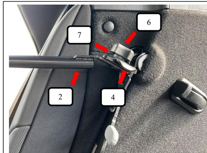
Streben rechts + links (Pos. 2) von unten an die Rücksitzbank-Verankerung halten, so dass, das Gewinde durch ragt. Von oben die Gegenplatte auflegen und jetzt eine Unterlegscheibe (Pos. 7) sowie Rändelmutter flach (Pos. 6) aufschrauben und festziehen.
