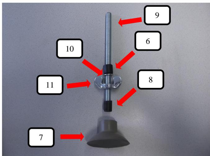
Auf die Gewindestange oben (Pos.9) eine Distanzhülse (Pos. 8) und dann einen Gummifuß grau (Pos.7) wie im Bild dargestellt aufstecken. Danach die Flügelmutter (Pos. 11) drauf drehen und die Unterlegscheibe (Pos. 10) aufstecken.
