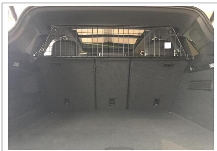
Trenngitter im montierten Zustand.
