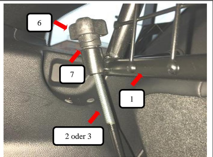
Gewindehaken (Pos. 2) oder (Pos. 3) durch die Kunststoffhülse (Pos. 7) im Trenngitter (Pos. 1) stecken und eine Rändelmutter gewölbt (Pos. 6) aufschrauben und festziehen. Darauf achten das der Gewindehaken (Pos. 2) oder (Pos. 3) wie auf Bild 4 unten in der Verzurröse eingehängt ist.
