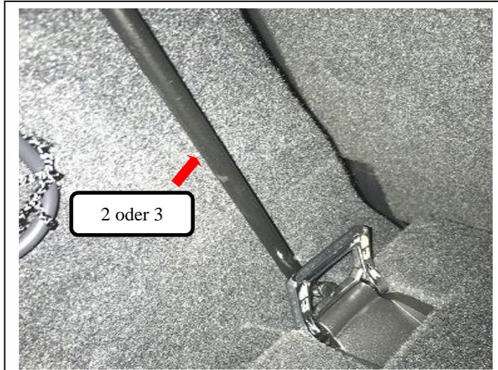
Gewindehaken (Pos. 2) (**Elektro Hybrid**) oder Gewindehaken (Pos. 3) (**nicht Elektro Hybrid**) in die hochgeklappte Verzurröse einhaken.
