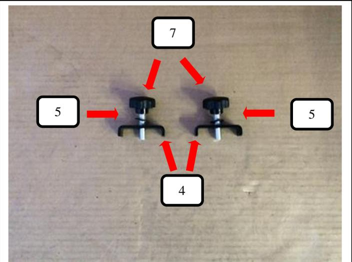
Die beiden U-Bügel (Pos. 4) zusammen mit jeweils einer Unterlegscheibe (Pos. 5) und Rändelschraube (Pos. 7) wie im Bild dargestellt zusammenbauen.
