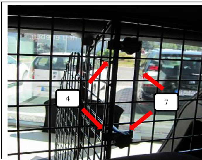
Raumteiler (1) in das Fahrzeug stecken, mit den Raumteiler (1) (Pos. 1) mittels der beiden Verschraubungen aus Bild 2 oben und unten am Trenngitter befestigen. Das Ende der Gewindebuchse mit den Rohrendkappen (Pos. 6) schützen.
