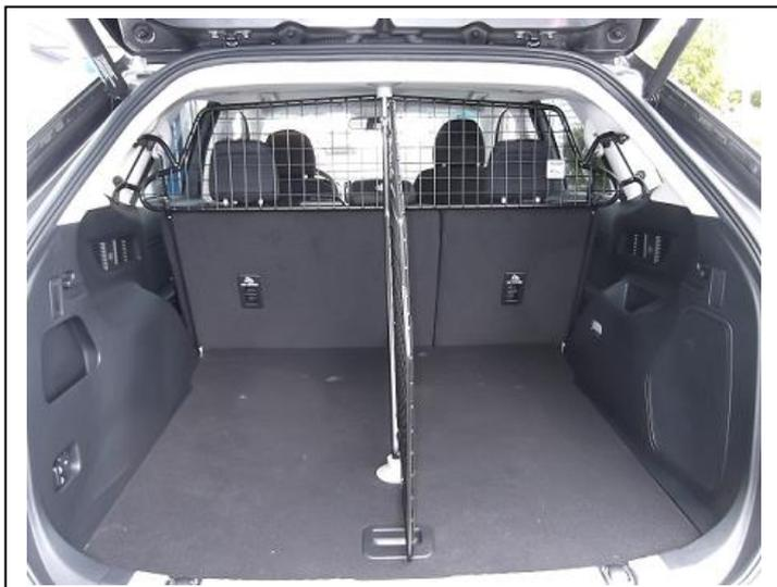
Raumteiler (Pos. 1) ggf. leicht ausrichten und final befestigen.
