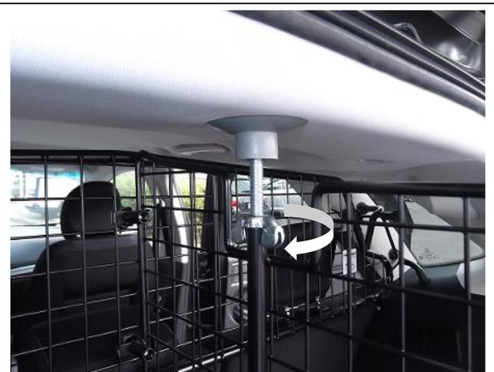
Oberen Feststellpunkt über drehen der Flügelschraube (Uhrzeigersinn) anziehen. **Achtung ! Feststellpunkt am Dachhimmel nicht zu fest anziehen, da Deformationen und Beschädigungen im Bereich des Dachhimmels möglich sind !**
