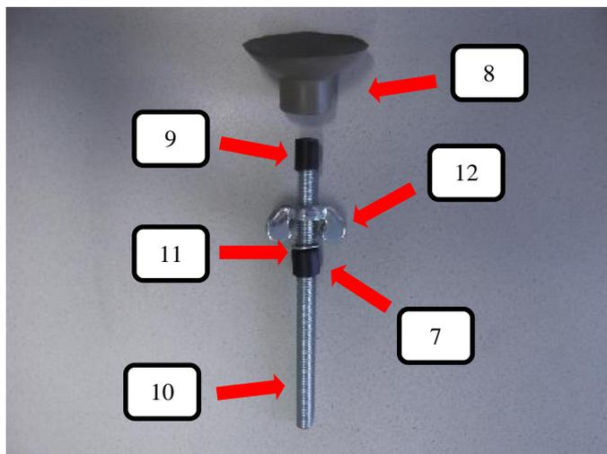
Auf die Gewindestange oben (Pos.10) die Distanzhülse (Pos. 9) und danach den Gummifuß (Pos. 8) aufstecken. Von der anderen Seite die Flügelmutter (Pos. 12) aufdrehen und dann die U-Scheibe (Pos. 11) und Durchführungskappe für Gewindestange (Pos. 7) aufschieben.
