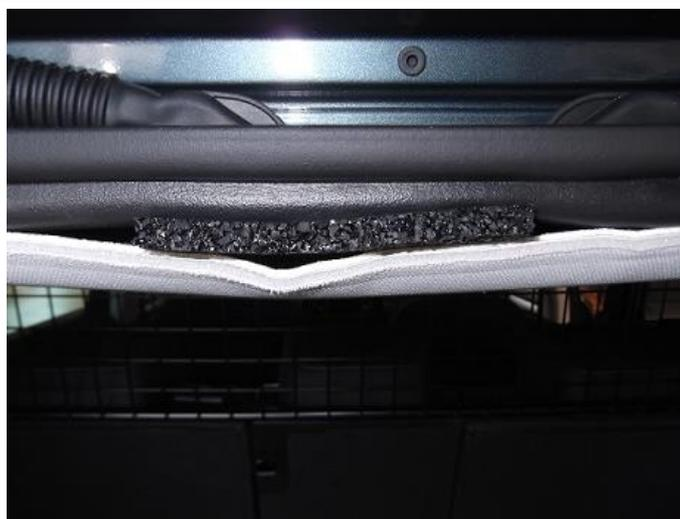
Im oberen Bereich der Hecktür die Gummiabdichtung leicht anheben und je nach gewünschter Position des Teilers die Gummimunterlage 8mm (Pos.8) im Bereich des Feststellpunktes in den Hohlraum schieben.
