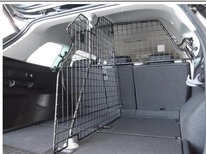
Teiler ggf. leicht ausrichten und final befestigen.
