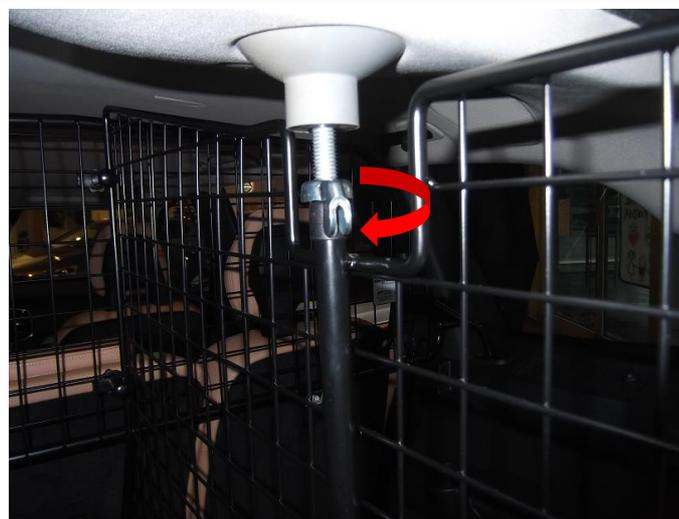
Oberen Feststellpunkt über drehen der Flügelschraube (Uhrzeigersinn) leicht anziehen.
