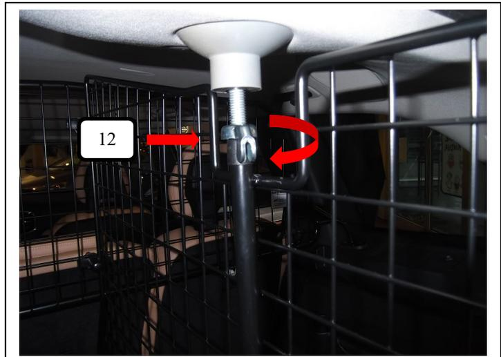
Oberen Feststellunkt über drehen der Flügelmutter (Pos. 12) (Uhrzeigersinn) leicht anziehen.
