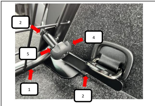
Trenngitter (Pos. 1) von hinten aus in das Fahrzeug einbringen und vor der C-Säule platzieren und auf den Bodenhalter L+R (Pos. 2) stellen. Nun von vorne eine Schlossschraube M8x45 (Pos. 4) durch das Trenngitter (Pos. 1) und den Bodenhalter L+R (Pos. 2) stecken, jetzt von der anderen Seite eine Unterlegscheibe M8 (Pos. 5) und Rändelmutter gewölbt (Pos. 6) aufschrauben und festziehen.
