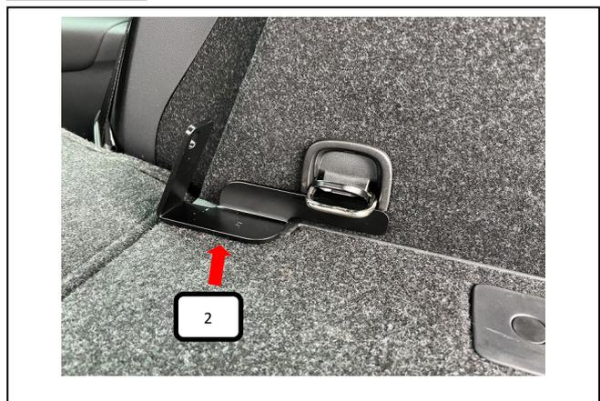
Bodenhalter L+R (Pos. 2) wie auf dem Bild in die Verzurröse einhängen.
