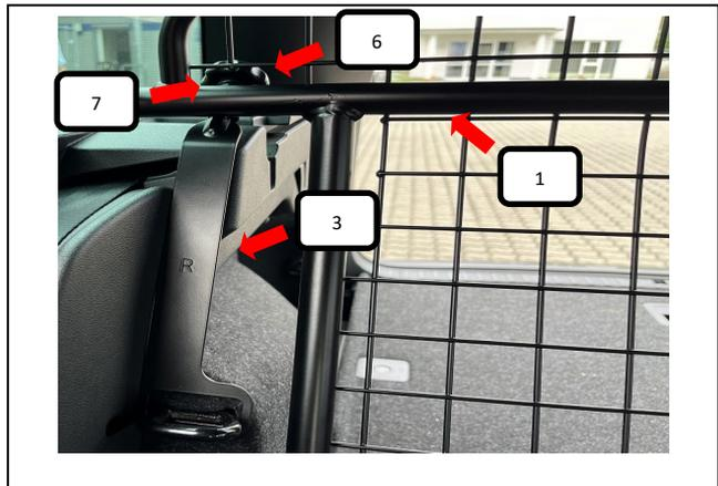
Gewindehaken (Pos. 3) über die Rücksitzbankverankerung führen, Gitter leicht anheben und jetzt durch die Kunststoffhülse (Pos. 7) sowie das Trenngitter (Pos. 1) schieben. Von oben jetzt die Rändelmutter gewölbt (Pos. 6) aufdrehen und festziehen.
