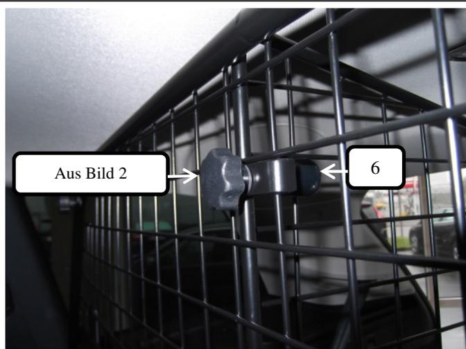
Nun den Teiler mittels der beiden Verschraubungen aus Bild 2 oben und unten am Trenngitter befestigen, und das Ende der Gewindebuchse mit den Rohrendkappen (Pos.6) schützen.
