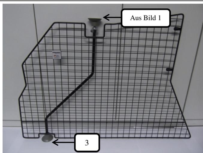
Wie im Bild dargestellt bitte die aus Bild 1 zusammengesetzte Gewindestange mit Gummifuss oben in die Rohröffnung des Teilers stecken (Feststellpunkt) und einen Gummifuss (Pos.3) unten am Teiler aufstecken.
