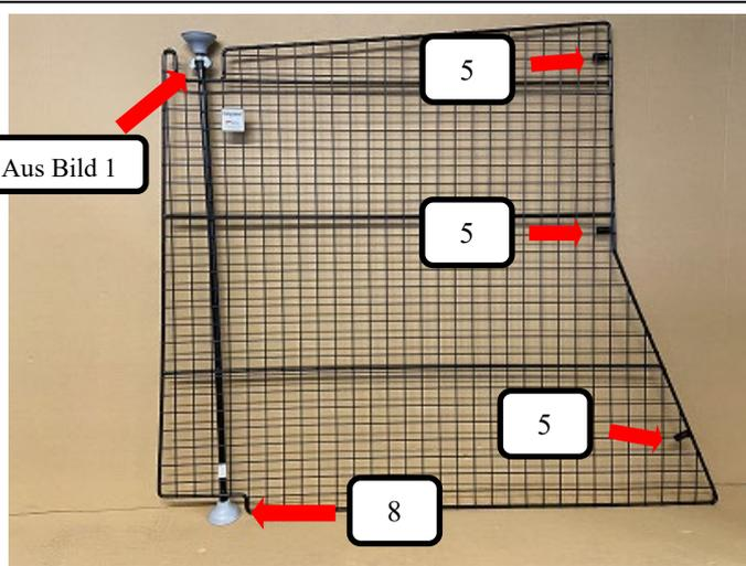
Wie im Bild dargestellt bitte die aus Bild 1 zusammengesteckte Gewindestange mit Gummifuß oben in die Rohröffnung des Teilers stecken (Feststellpunkt) und einen Gummifuß (Pos.8) unten am Teiler aufstecken. Die drei Rohrendkappen (Pos. 5) auf den Teiler (Pos. 1) drücken.
