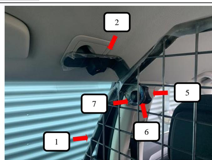
Trenngitter (Pos. 1) von der Seite aus in das Fahrzeug einbringen, mit einer Schlossschraube (Pos. 7), Unterlegscheibe (Pos. 6) und Rändelmutter flach (Pos. 5) am Dachhalter (Pos. 2) befestigen und festziehen.
