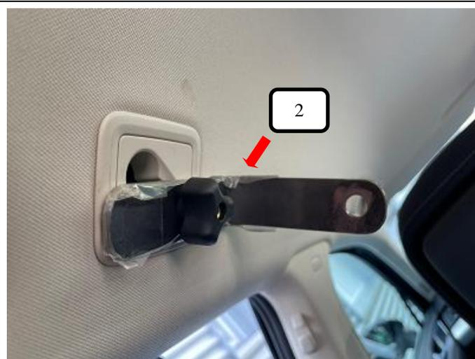
Vormontierten Dachhalter (Pos. 2) aus Bild 1, wie zu sehen in die original Netzaufhängungen einhängen und festziehen.
