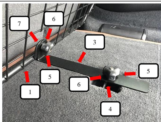
Gewindehaken kurz (Pos. 4) an die Isofix-Verankerung einhängen und durch den Bodenhalter (Pos. 3) stecken, jetzt eine Unterlegscheibe (Pos. 6) und Rändelmutter flach (Pos. 5) aufschrauben und festziehen. Den Bodenhalter (Pos. 3) mit einer Schlossschraube (Pos. 7), Unterlegscheibe (Pos. 6) und Rändelmutter flach (Pos. 5) mit dem Trenngitter (Pos. 1) verbinden und festziehen.
