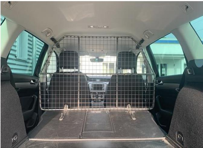
Trenngitter im montierten Zustand.
