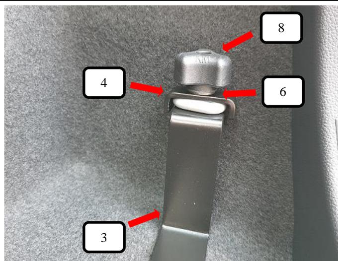
Bodenhalter (Pos. 3) von unten an die Verzurröse halten, so dass das Gewinde durch zeigt. Von oben die Gegenplatte (Pos. 4) über das Gewinde stecken, jetzt eine Unterlegscheibe (Pos. 6) und Rändelmutter flach (Pos. 8) aufschrauben und festziehen.
