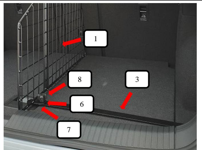
Auf der anderen Seite des Bodenhalters (Pos. 3), von unten die Schlossschraube (Pos. 7) durchstecken, jetzt den Teiler (Pos. 1) darüber stellen und von oben eine Unterlegscheibe (Pos. 6) sowie Rändelmutter flach (Pos. 8) aufschrauben und festziehen.
