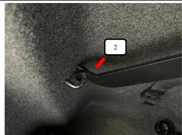
Stützstrebe rechts + links (Pos. 2) wie auf dem Bild, auf beiden Seiten in die Verzurösen einhängen.
