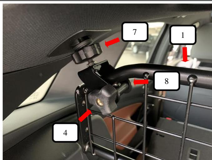
Trenngitter (Pos. 1) in das Fahrzeug einbringen und auf beiden Seiten zwischen die Dachhalterung (Pos. 7) halten. Jetzt auf jeder Seite eine Schlossschraube M8x50 (Pos. 8) durchstecken und von der anderen Seite eine Rändelmutter flach (Pos. 4) aufschrauben und festziehen.
