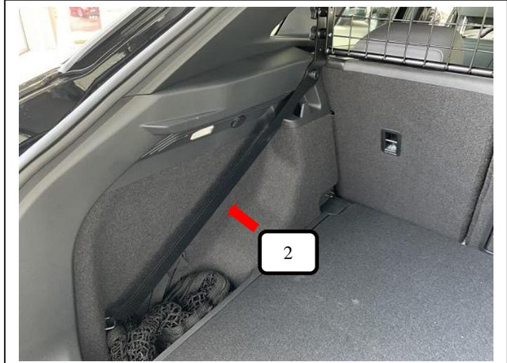
Stützstrebe rechts + links (Pos. 2) richtig montiert.
