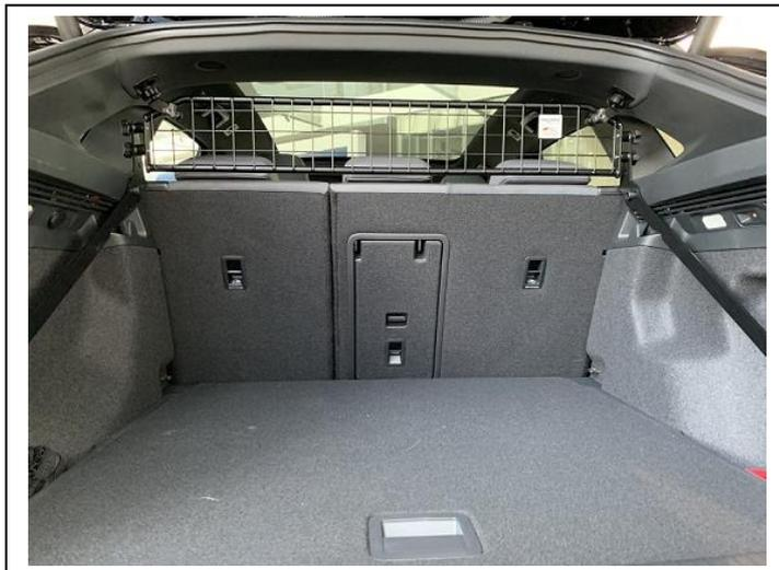
Trenngitter im montierten Zustand.
