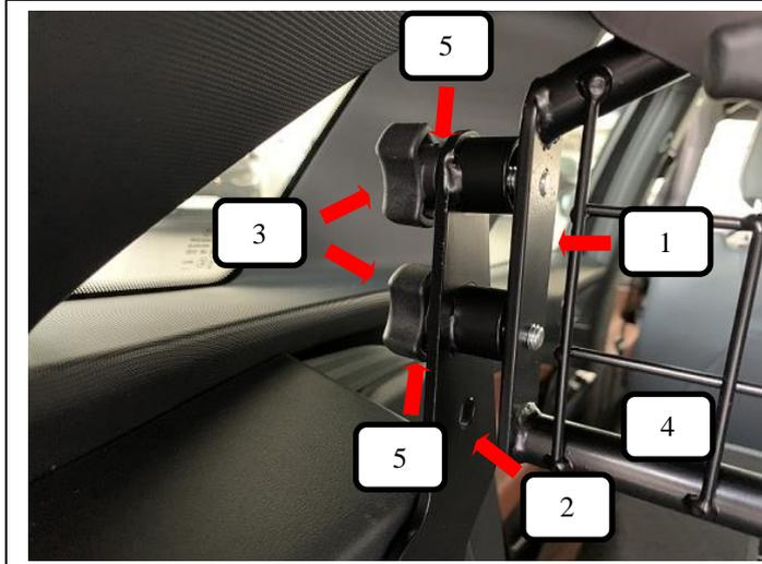
Jetzt die Stützstrebe rechts + links (Pos. 2) außen an das Trenngitter (Pos. 1) führen, auf beiden Seiten von außen zwei Rändelschrauben M8x30 (Pos. 3) sowie zwei Unterlegscheiben (Pos. 5) befestigen. Hierfür muss die Rändelschraube M8x30 (Pos. 3) mit der Unterlegscheibe (Pos. 5) durch die Stützstrebe rechts + links (Pos. 2) geschoben und in das Gewinde des Trenngitter (Pos. 1) geschraubt werden.
