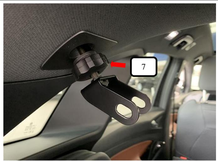
Dachhalterung (Pos. 7) wie auf dem Bild in die Originalnetzaufhängungen einhängen und festziehen.
