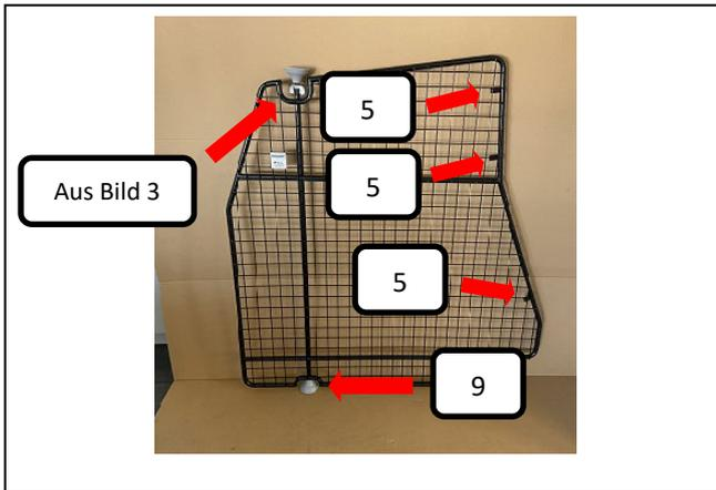
Wie im Bild dargestellt bitte die aus Bild 3 zusammen-gesteckte Gewindestange mit Gummifuß oben in die Rohröffnung des Teilers stecken (Feststellpunkt) und einen Gummifuß (Pos.9) unten am Teiler aufstecken. Die drei Rohrendkappen (Pos. 5) auf den Raumteiler (Pos. 1) drücken.
