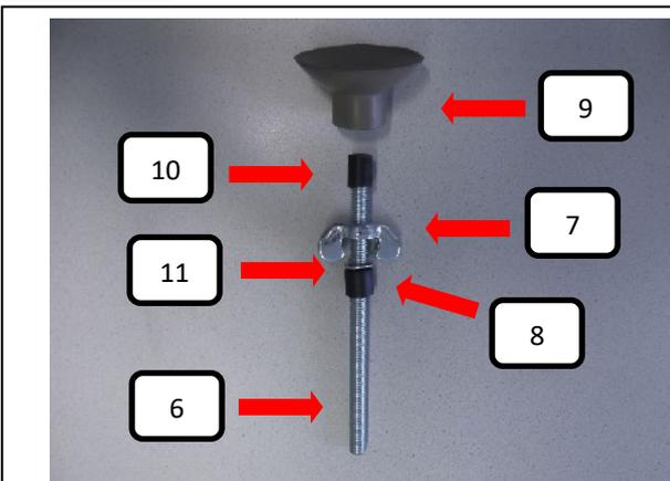
Auf die Gewindestange oben (Pos.6) die Distanzhülse (Pos. 10) und danach den Gummifuß (Pos. 9) aufstecken. Von der anderen Seite die Flügelmutter (Pos. 7) aufdrehen und dann die U-Scheibe (Pos. 11) und Durchführungskappe (Pos. 8) aufschieben.
