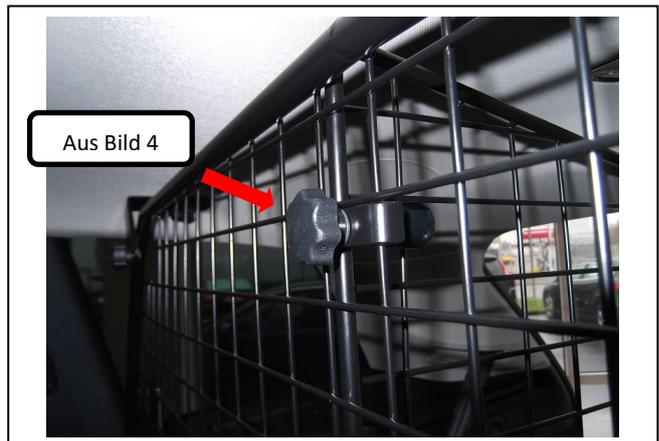
Nun den Teiler mittels der drei Verschraubungen aus Bild 4 am Trenngitter befestigen.
