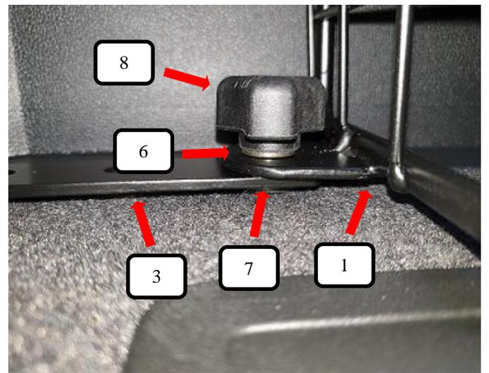
Auf der anderen Seite des Bodenhalters (Pos. 3), von unten die Schlossschraube (Pos. 7) durchstecken, jetzt den Teiler (Pos. 1) darüber stellen und von oben eine Unterlegscheibe (Pos. 6) sowie Rändelmutter flach (Pos. 8) aufschrauben und festziehen.
