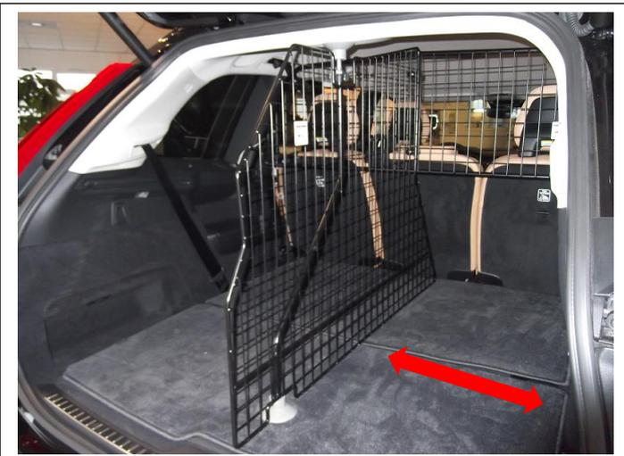
Teiler ggf. leicht ausrichten und final befestigen.
