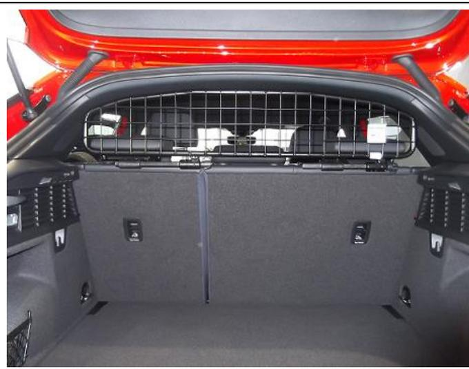
Trenngitter im montierten Zustand.
