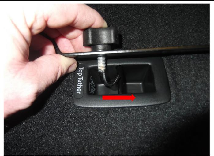
Wie im Bild dargestellt die aus Bild 3 zusammengebauten Bodenhalter in die Aufnahme der Rücksitzbank einhängen, festhalten und leicht befestigen.
