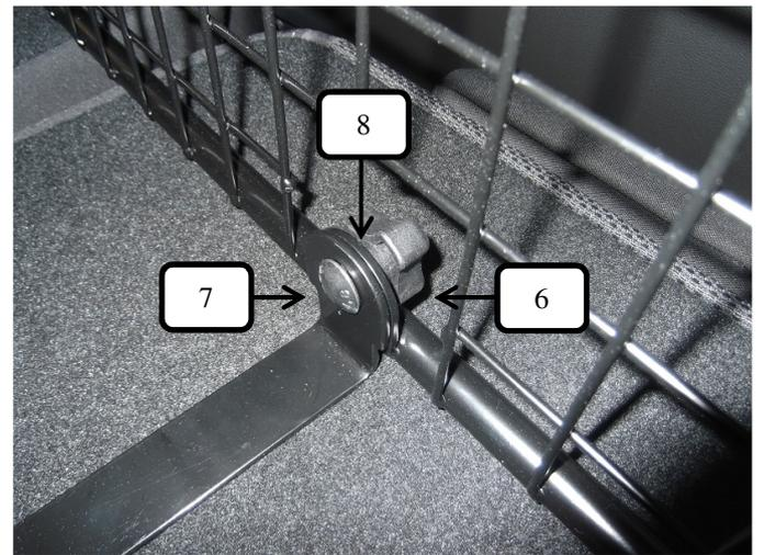
Nun das Trenngitter an den beiden Bodenhalter ebenfalls mit einer Schlossschraube (Pos. 7), Unterlegscheibe (Pos. 8) und Rändelmutter (Pos. 6) leicht befestigen.
