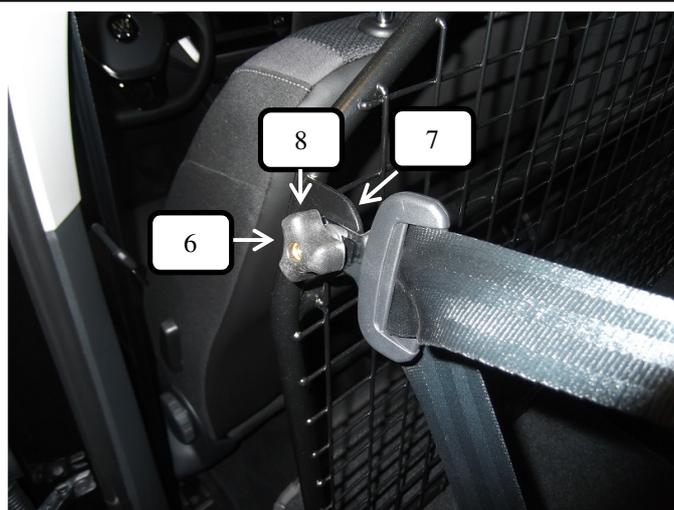
Jetzt an den beiden seitlichen Aufnahmen am Trenngitter jeweils den Sicherheitsgurt zusammen einer Schlossschraube (Pos. 7), Unterlegscheibe (Pos. 8) und Rändelmutter (Pos. 6) leicht befestigen.
