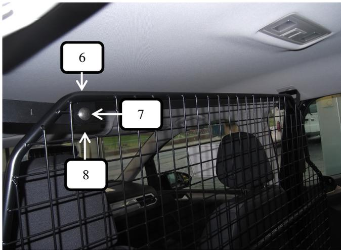
Trenngitter ins Fahrzeug einbringen und oben an den beiden Dachhalter zusammen mit einer Schlossschraube (Pos. 7), Unterlegscheibe (Pos. 8) und Rändelmutter (Pos. 6) leicht befestigen.
