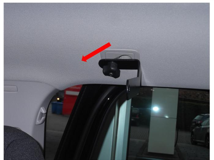
Wie im Bild dargestellt die aus Bild 1 zusammengebauten Dachhalter oben in die Fahrzeugseitigen Aufnahmeösen einhängen, nach unten schieben, festhalten und leicht befestigen.
