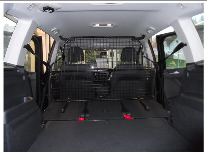
Trenngitter ausrichten, und zum Schluss alle Befestigungspunkte anziehen.
