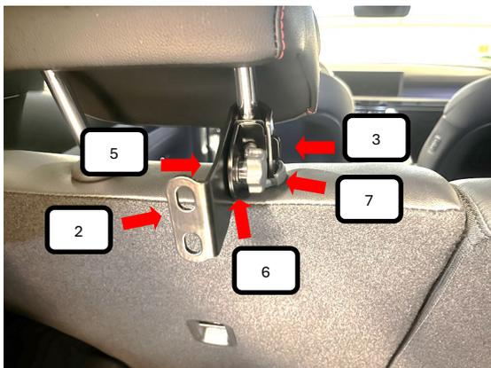
Jetzt von der linken Seite aus eine Schlossschraube (Pos. 5) durch die Winkelstütze (Pos. 2+3) stecken, von der anderen Seite jeweils eine Unterlegscheibe (Pos. 6) und Rändelmutter (Pos. 7) aufschrauben und festziehen.
