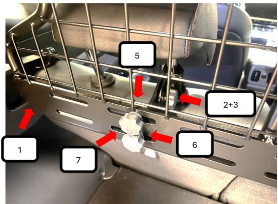
Das Trenngitter (pos. 1) an die montierten Winkelstützen (Pos 2+3) halten und vom Fahrgastraum eine Schlossschraube (Pos. 5) durchstecken, von der anderen Seite jeweils eine Unterlegscheibe (Pos. 6) und Rändelmutter (Pos. 7) aufschrauben und festziehen.
