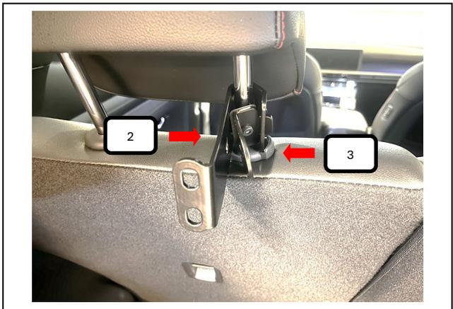
Jetzt die Winkelstütze Haken (Pos. 2) um die Kopfstützenstangen führen und dann die Winkelstütze Klemmbacke (Pos. 3) einhängen.
