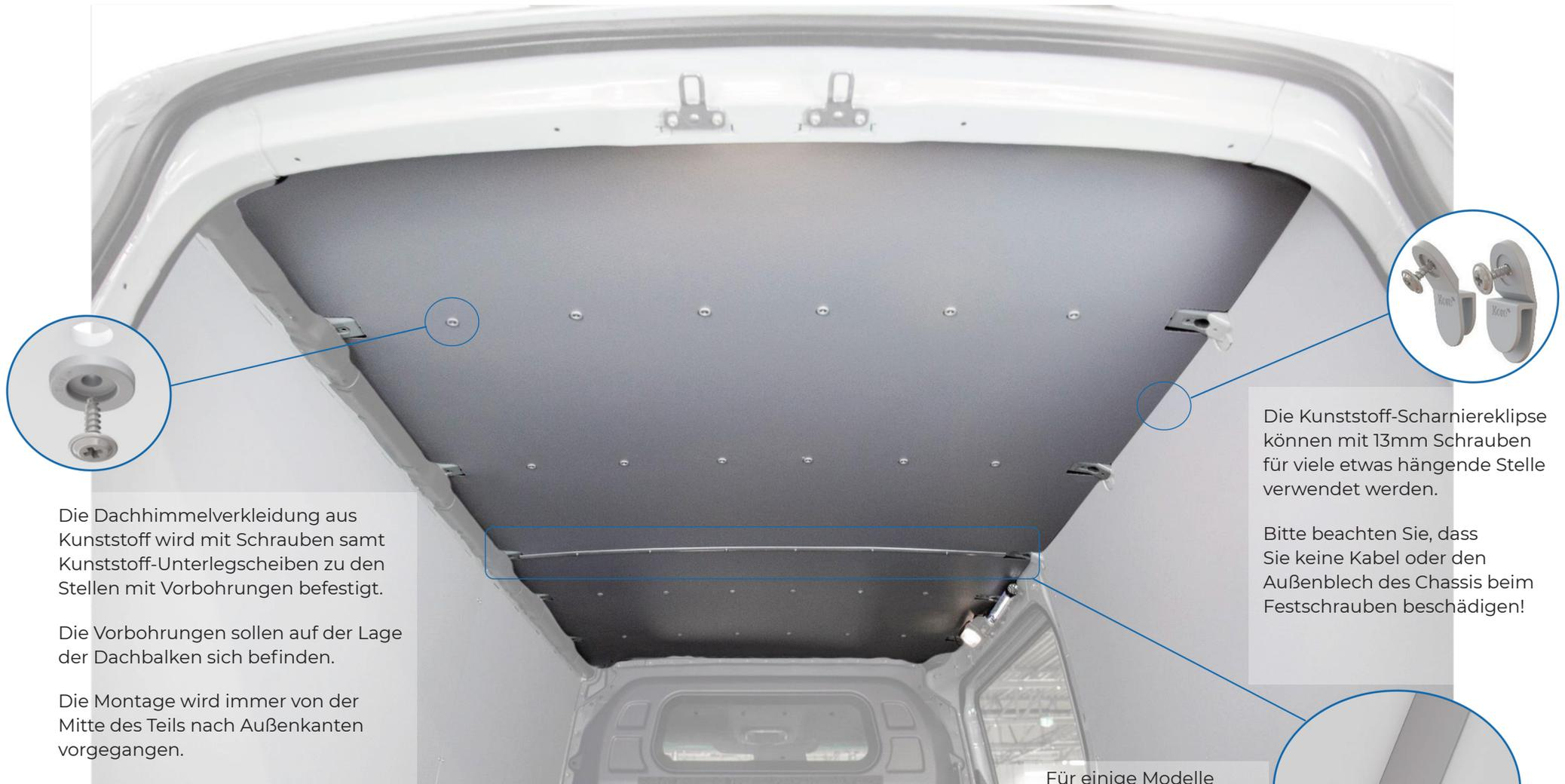
Die Dachhimmelverkleidung aus Kunststoff wird mit Schrauben samt Kunststoff-Unterlegscheiben zu den Stellen mit Vorbohrungen befestigt.
