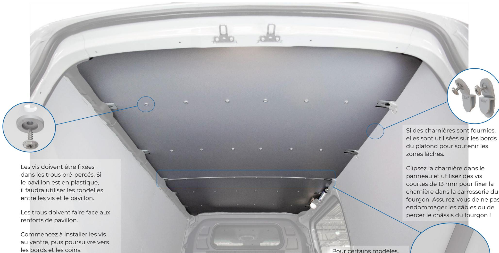
Les vis doivent être fixées dans les trous pré-percés. Si le pavillon est en plastique, il faudra utiliser les rondelles entre les vis et le pavillon.
