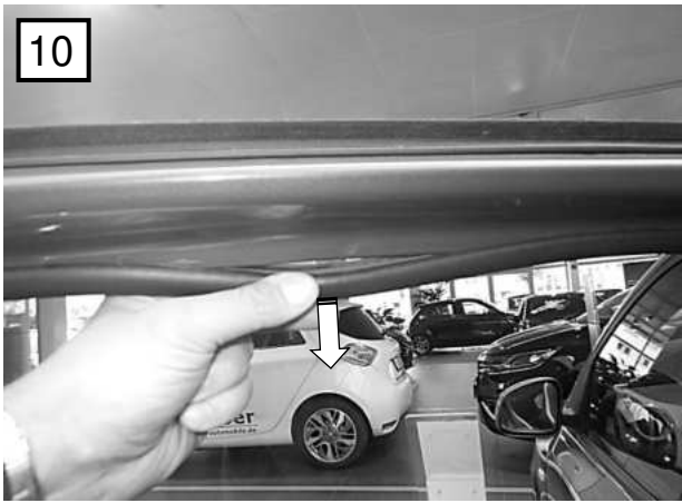
10 Fenstergummi abziehen / remove the window rubber
